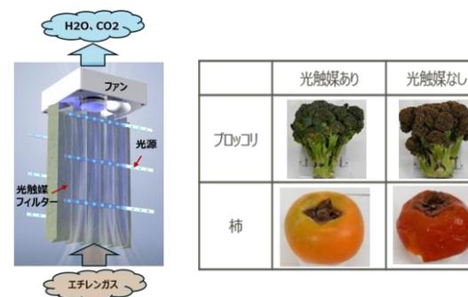
独自合成プロセスにより圧倒的に高性能化した光触媒材料を、フィルターに高密度付着させることで、高ガス分解性能をもつガス分解モジュールを実現。効率よくエチレングスを分解できるので、生鮮品の鮮度保持などに活用できます。
